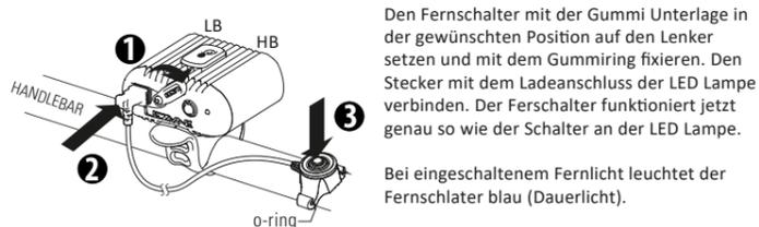
Den Fernschalter mit der Gummi Unterlage in der gewünschten Position auf den Lenker setzen und mit dem Gummiring fixieren. Den Stecker mit dem Ladeanschluss der LED Lampe verbinden. Der Fernschalter funktioniert jetzt genau so wie der Schalter an der LED Lampe.
